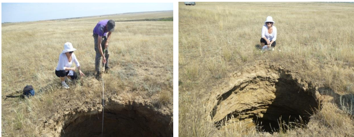
Рисунок 1.4 - Замеры размеров провалов в земле возле месторождения Карачаганак под руководством Кошим А.Г.
