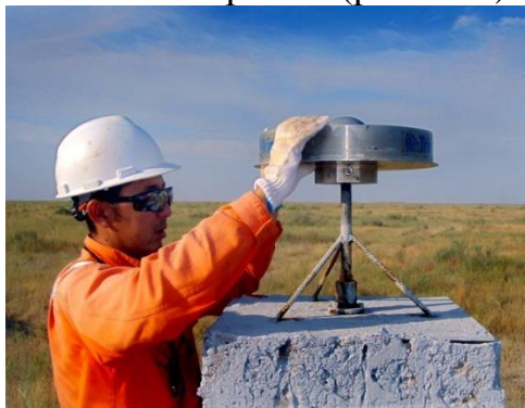
Рисунок 1.14 - Геодинамические наблюдения на нефтяном месторождении, выполняемые НПЦ «Геокен» и РГКП «КазГеодезия» [37]
